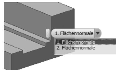
Um die Wartezeit auf das Auswahlménü zu verkürzen, können Sie nach Selektion einer Kante / Fläche über das Kontextménü und dem Befehl **Andere auswählen...** das Auswahlménü selbständig öffnen.
