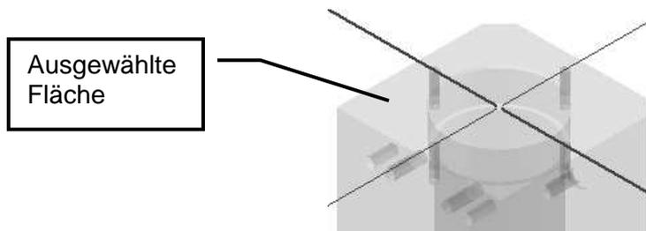
Nach Auswahl der Fläche wird sofort das Bauteil im Browser angelegt. Wurde der Schalter **Skizzierebene von gewählter Fläche oder Ebene abhängig machen** aktiviert, wird sofort eine Zusammenbauabhängigkeit zwischen den zwei Bauteilen vergeben. Erstellen Sie nun über den Befehl **2D-Skizze** eine Skizzierebene.
