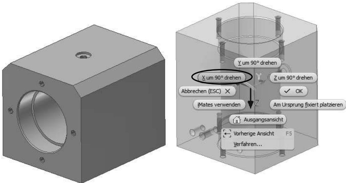
Über das Mini-Menü können Sie angeben, ob die zuzuordnende Komponente über die **X-, Y- oder Z-Achse** gedreht positioniert werden soll. Des Weiteren können Sie über die Funktion **Am Ursprung fixiert platzieren** angeben, ob die zuzuordnende Komponente über deren Ursprungsebenen an den Ursprungsebenen der Baugruppendatei fixiert positioniert werden soll. Nach dem die zugeordnete Komponente fixiert wurde, wird dies im Browser über eine Pinnadel Gehaeuse:1 angezeigt.
