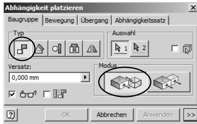
Abb.: Dialogbox **Abhängigkeit platzieren** Register **Baugruppe** Typ **Passend**
