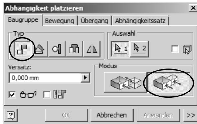
Abb.: Dialogbox **Abhängigkeit platzieren** Register **Baugruppe** Typ **Fluchtend**
