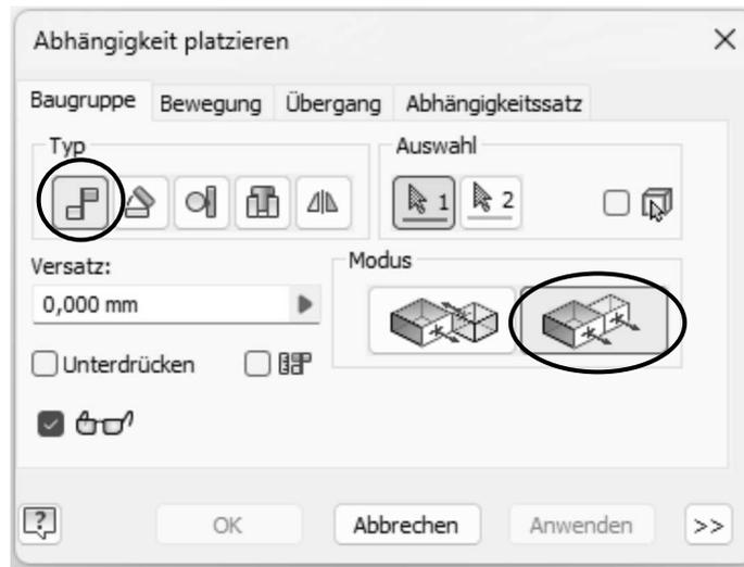
Abb.: Dialogbox **Abhängigkeit platzieren** Register **Baugruppe** Modus **Fluchtend**
