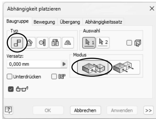
Abb.: Dialogbox **Abhängigkeit platzieren** Register **Baugruppe** Modus **Passend**
