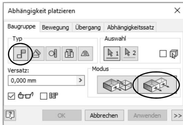
Abb.: Dialogbox **Abhängigkeit platzieren** Register **Baugruppe** Modus **Fluchtend**
