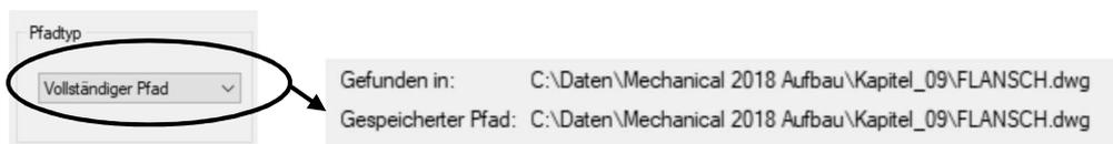
Wenn Sie den Pfadtyp **Kein Pfad** verwenden, wird für die Verknüpfung der Tochterzeichnung nur der Dateiname hinterlegt. Beim Öffnen der Mutterzeichnung werden alle Laufwerke und Ordner nach dem Dateinamen gesucht. Die erste Datei, die das System findet, wird dann für die Mutterzeichnung herangezogen.
