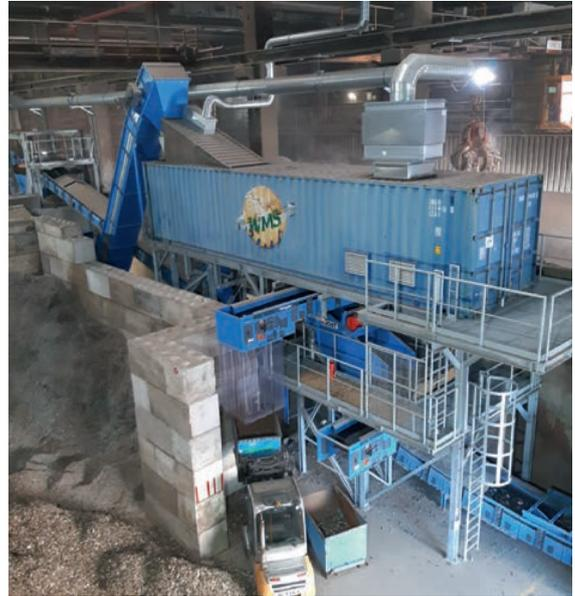
Mit Advance Steel entstehen Wartungsbühnen für Förderbänder und Aufbereitungsanlagen schnell und sicher.
