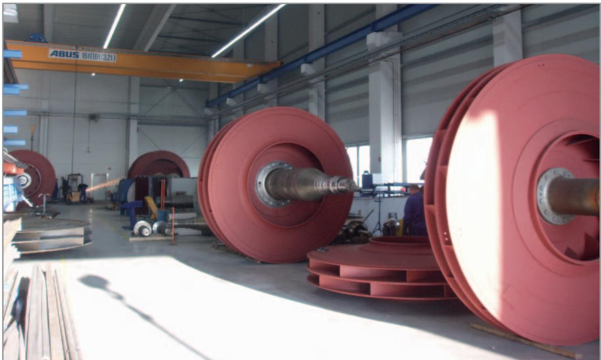
Solche Laufräder werden in unzähligen Varianten benötigt. Mit customX werden die Fertigungsunterlagen automatisch erstellt. Im Bild ein Laufrad mit Welle für einen zweiseitig saugenden Ventilator. Der Laufraddurchmesser beträgt ca. 3,8 Meter.
