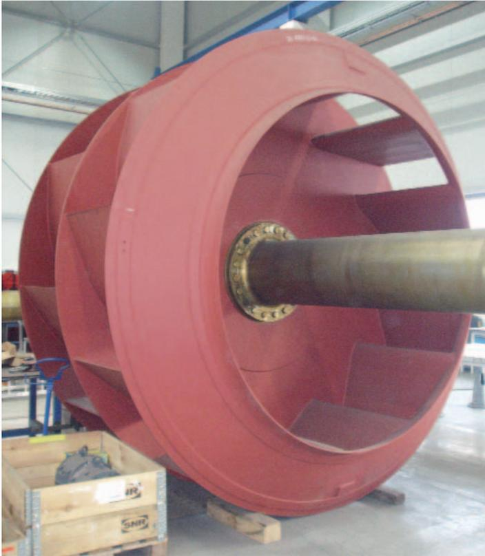
Dieses Laufrad für einen zweiseitig saugenden Ventilator ist mit Profilschaufeln für höchste Wirkungsgrade ausgestattet.
