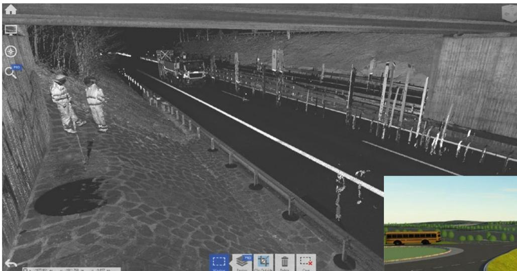
BIM macht vieles möglich, z. B.: Anhand eines ausgewerteten 3D-Laserscans lässt sich das Bestandsmodell einer Autobahn erzeugen (oben). Die komplexe Verbausituation bei einer Bahnbrücke lässt sich mit Revit modellieren und mit dem MuM BIM Booster auswerten (rechts).
