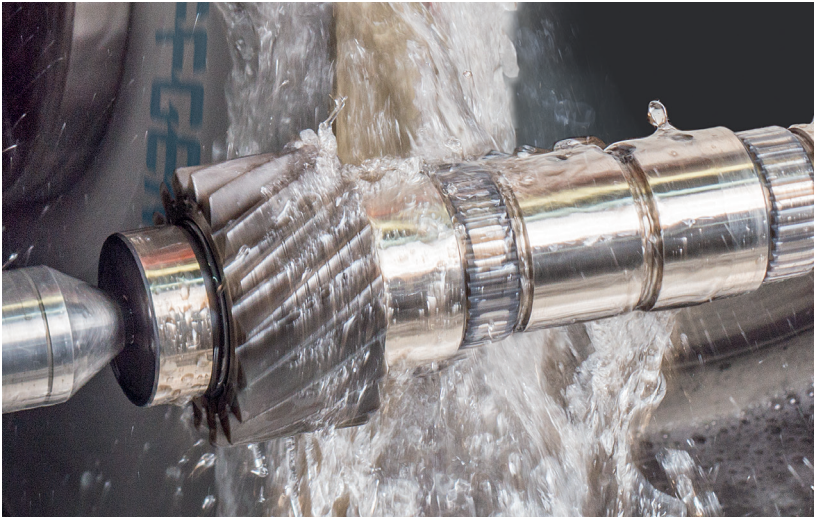
Was in Getriebe eingebaut wird, muss präzise geschliffen sein: Effen-Werkzeuge schleifen z. B. Wellen für PKW-Getriebe
