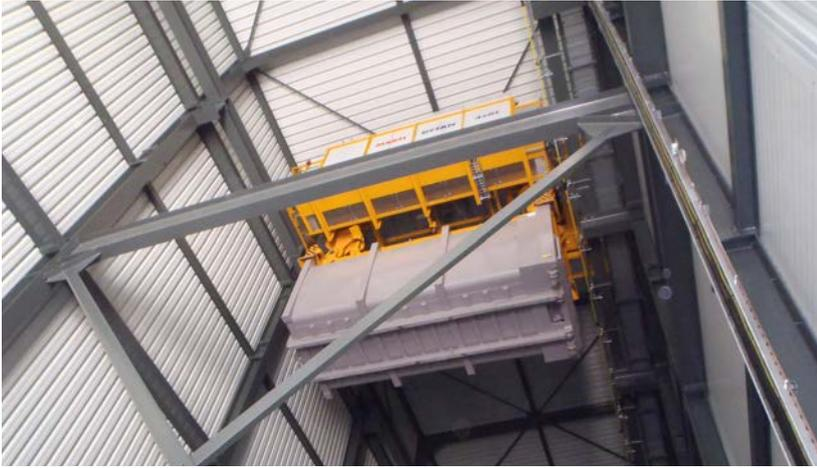
Der Zweiträgerlaufkran bei einer Schweizer Firma setzt volle und leere Transportcontainer im 130m langen Containerlager um und stapelt sie.
