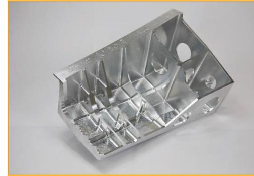
**Projekt:** Plane Flächen 10x schneller fräsen durch neuartige Kegelfräser mit leicht konvexer Krümmung. Bearbeitungszeit für dieses Flugzeug-Leichtbauteil: Gesamt 2h05min statt 10h30min
