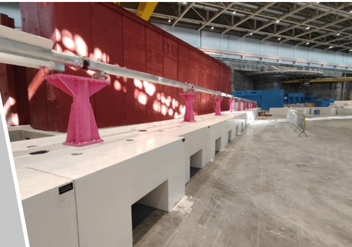
Neutronen sausen durch die Spezialleiter und machen Verborgenes sichtbar.
