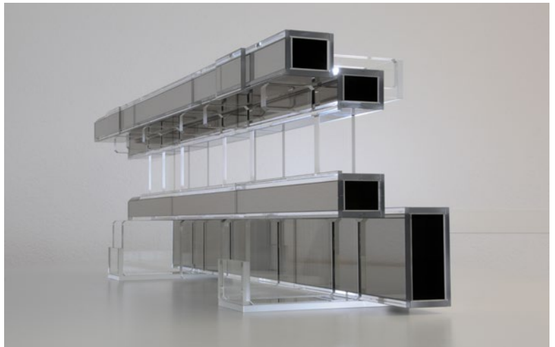
Neutronen-Spiegelkanäle können je nach Anwendung verschiedene Formen und Ausprägungen haben.
