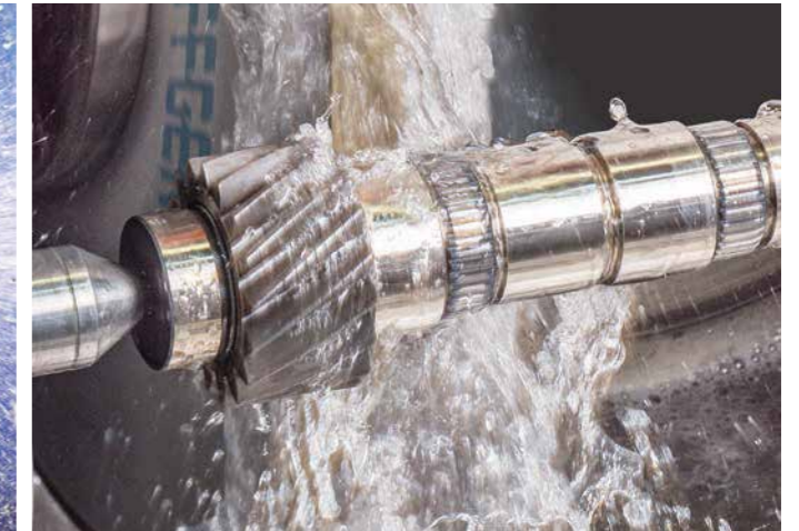
Was in Getriebe eingebaut wird, muss präzise geschliffen sein: Effgen-Werkzeuge schleifen z. B. Wellen für PKW-Getriebe
