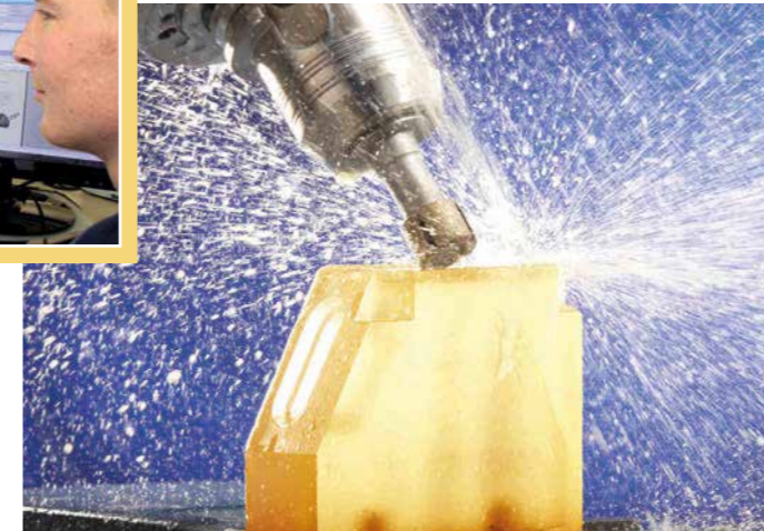
Präzisionswerkzeuge von Effgen kommen auch bei der Bearbeitung von Glaskeramiken wie Zerodur zum Einsatz
